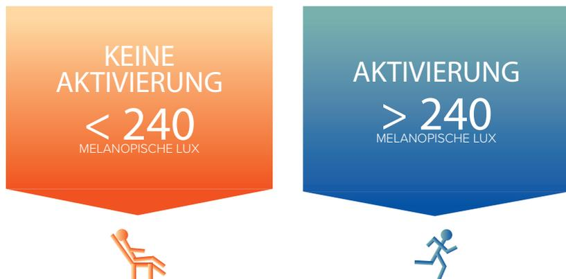
Für die nichtvisuelle Planung wird eine **Aktivierungsphase** vorgesehen (z. B. von 07:00 Uhr bis 11:00 Uhr Vormittag), in der **200 bis 250lx** an melanopisch bewerteten, tageslichtäquivalenten Beleuchtungsstärken vertikal am Nutzeraugpunkt geplant werden.
