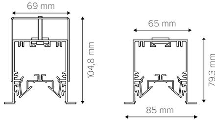
Deckenausschnitt = Leuchtenlänge + 2 mm, Breite 71 mm, Höhe min. 100 mm
