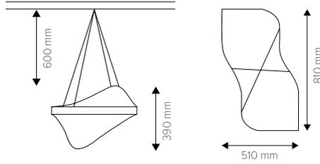
Max. Pendellänge: 1,5 m (mit 0,9 m Einzelseilabhängung).
