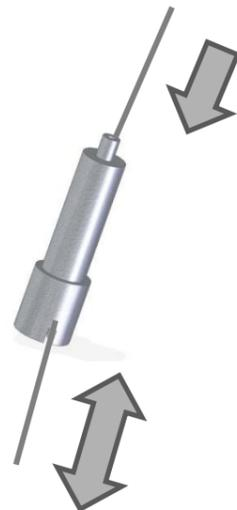
Einstellung Hängehöhe der Leuchte / *height adjustment of the luminaire*
