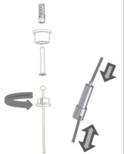
Montage der Seilabhänger an der Decke und Seile einziehen / *Mounting on the ceiling with the cord suspension*
